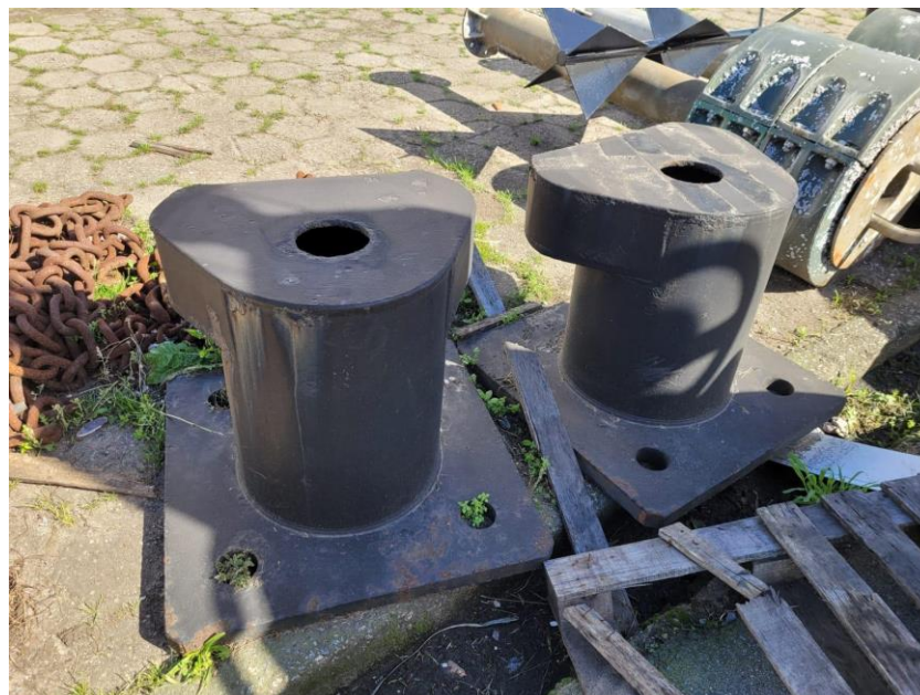
Figura 03: Foto do cabeço disponível para instalação.
